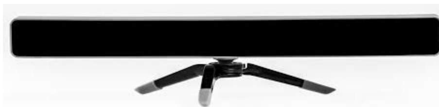
Urządzenie do badania ruchów gałki ocznej EyeTribe firmy The EyeTribe
