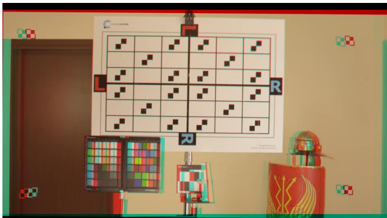
Rys. Anaglif stereopary do korekty generowany przez aplikację Disparity Checker w fazie szacowania dysparycji skali.
