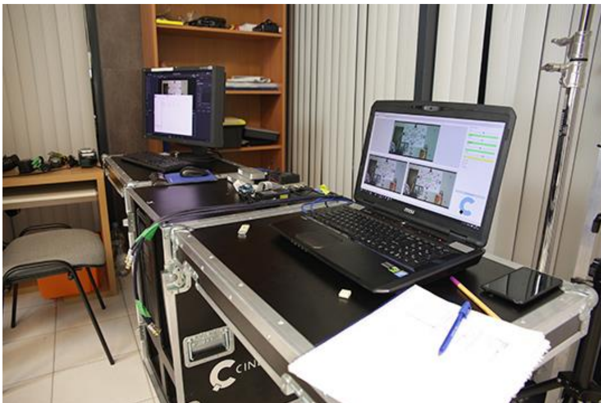
Rys. Dwa stanowiska kontrolne do identyfikacji ustawień błędu stereopary.
